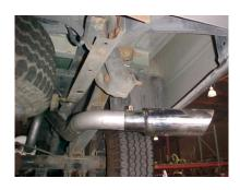
**INSTALL STAINLESS TIPS** TIGHTEN ALL CLAMPS AND HANGERS STARTING FROM THE MUFFLER BACK.. USE ZIP TIES FOR BRAKE & VENT LINES.
